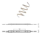
Technische Daten Ledvance LED-Streifen Value 2000 70W 6860lm 24v - 840 Kaltweiß | IP66 - 5M/10mm
