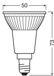
**Technische Daten Ledvance LED Reflektor E14 PAR16 3.7W 350lm 36d - 827 Extra Warmweiß | Ersatz Für 25W**[Produkt ansehen](#)**Technische Daten**
